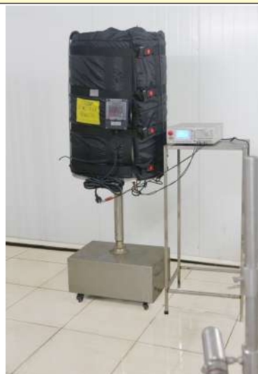
Измерение сопротивления изоляции после испытаний IPx6
