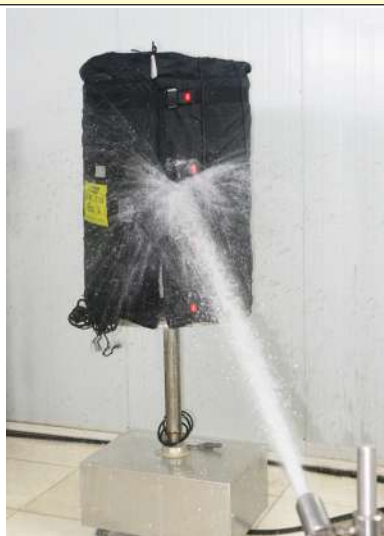
Испытание нагревателей рубашки на степень защиты IPx6
