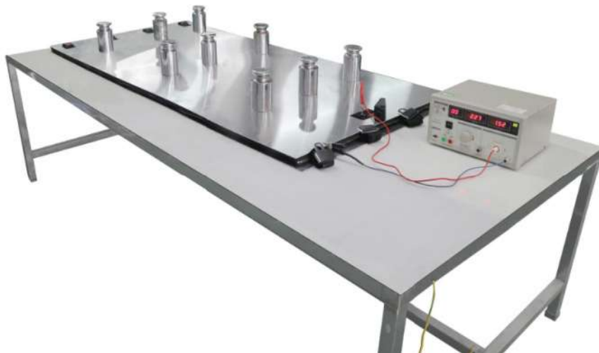
Измерительное оборудование для измерения полного тока утечки в холодном состоянии
